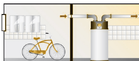
Adega. Permite aproveitar a temperatura ambiente interior para melhorar o rendimento da bomba.
