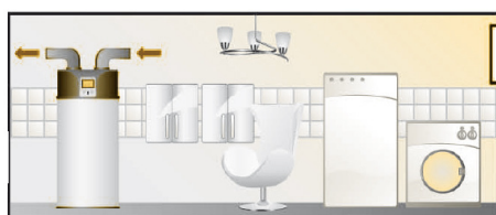
Lavandaria. Permite a desumidificação do ambiente e aproveitar a energia libertada pelos electrodomésticos durante o seu funcionamento.
