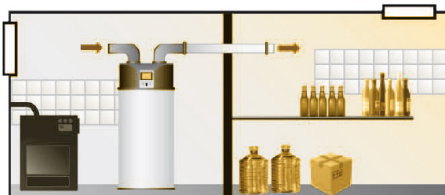
Sala de caldeiras. Permite aproveitar o calor gerado no local durante o seu funcionamento e refrigerar a adega.
